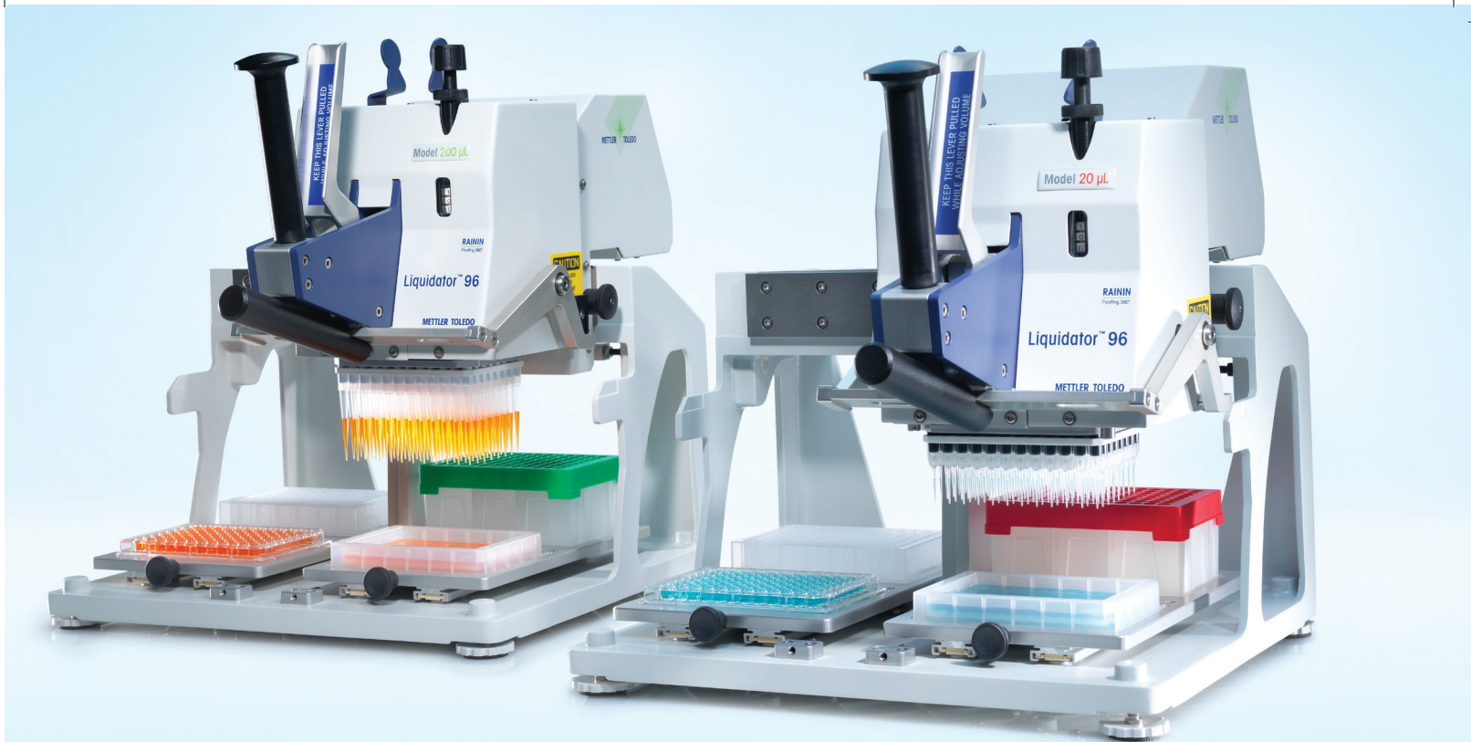
20 µL 和 200 µL Liquidator 提供出色的量程范围和性能
